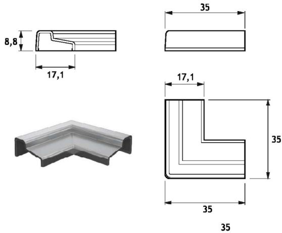
REDUCTA elemento di giunzione a 90° per profilo di contenimento IPD02
